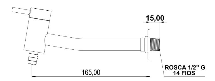
CORPO: METAL AREJADOR: FIXO, METAL, PARA MANGUEIRA MECANISMO DE VEDAÇÃO: 1/4 VOLTA PESO APROXIMADO: 0,300 grs
